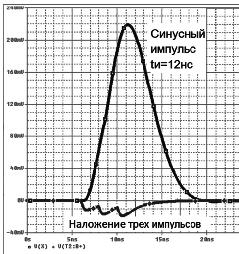
Рисунок 13. Упрощенная схема одного канала модуля TOFAddOn, реализующего модифицированный двухканальный TOT метод (вверху) и форма импульса синусного формирователя (внизу) при наложении входных импульсов
