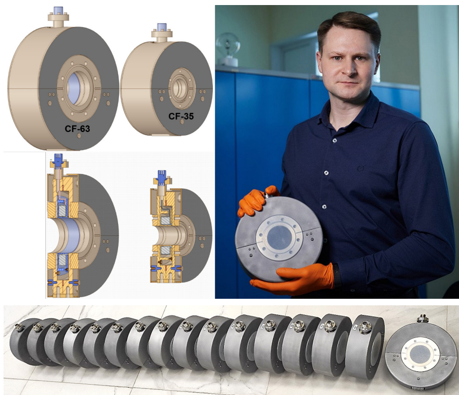
Рисунок 2.1.1 – Разработанные трехмерные модели ИДТ с апertурами 60 мм и 33 мм, фотография изготовленного ИДТ с апertурой 60 мм в руках автора и фотография комплекта изготовленных ИДТ для ЛУ РФЯЦ-ВНИИЭФ
