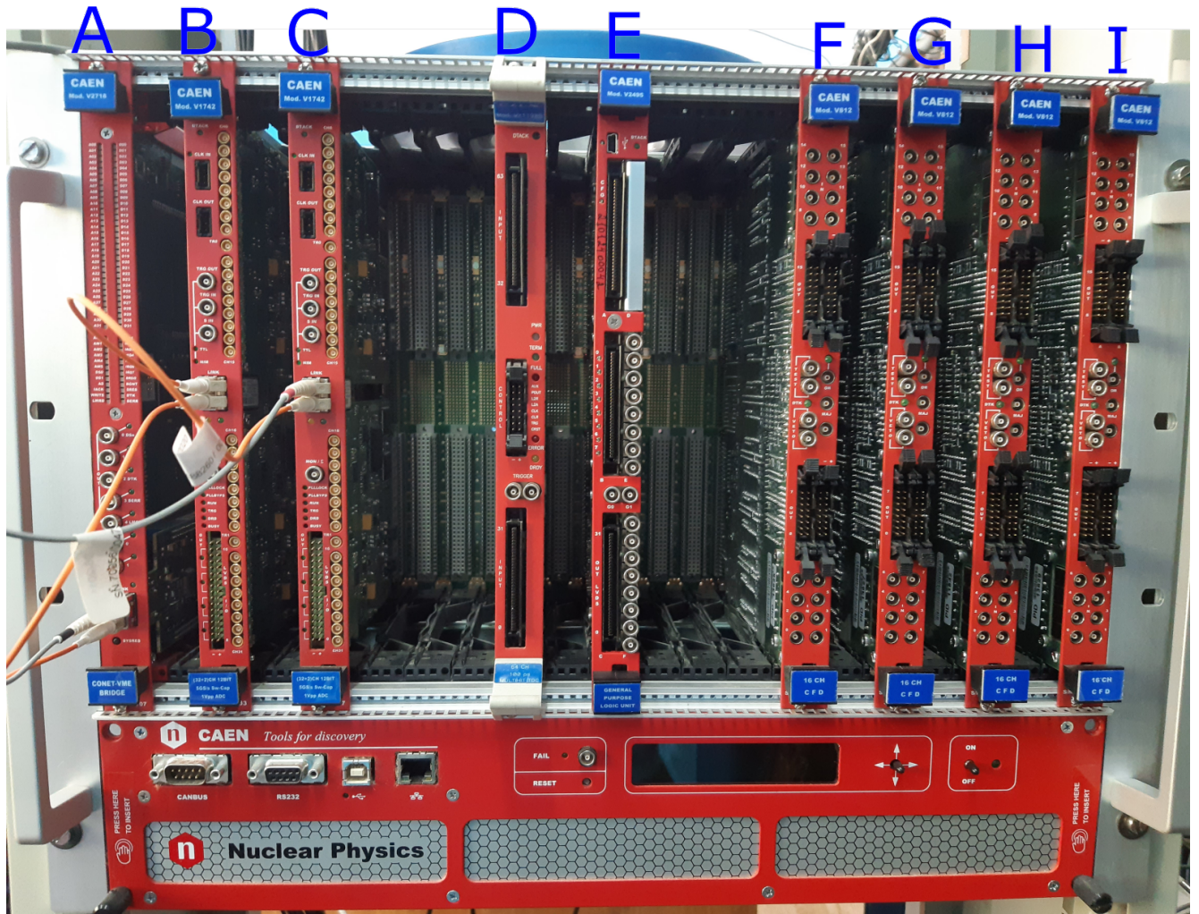
Рисунок 4.5 — Фотография крейта VME8100/00 и электроники, входящих в состав системы сбора данных наземной части установки «Ковер-3». Обозначения: (A) – Крейт-контроллер V2718; (B, C) – аналого-цифровой преобразователь V1742; (D) – время-цифровой преобразователь V1190B; (E) – логический блок V2495; (F–I) – временные дискриминаторы с плавающим порогом V812.
