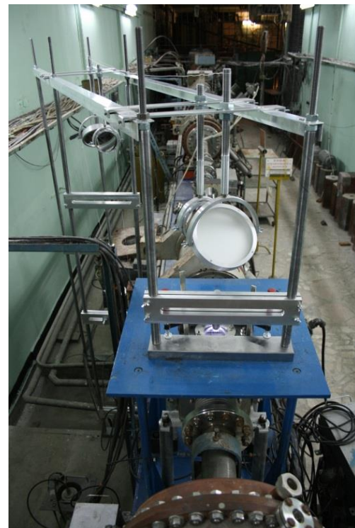
Рис. 50. Фотографии зеркально-линзового тракта ИМПС.
