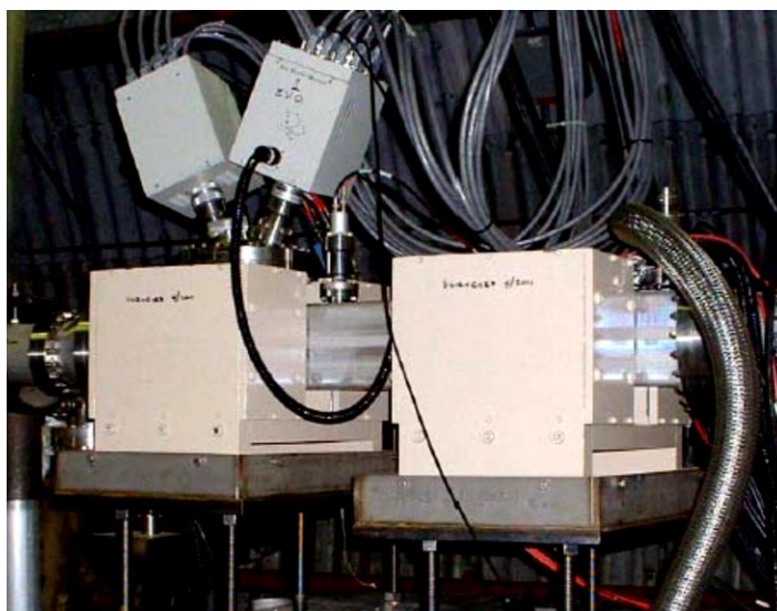
Рис. 13. Фотография профилометра RHIC: основной и корректирующий магниты.
