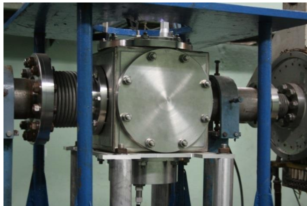
Рис. 65. Вакуумный бокс ИМПС, установленный на выходе ЛУ ИЯИ РАН.
