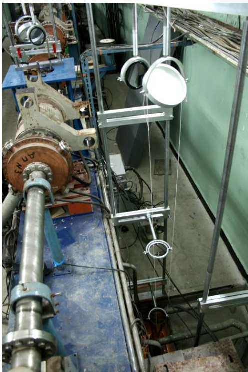
Рис. 50. Фотографии зеркально-линзового тракта ИМПС.
