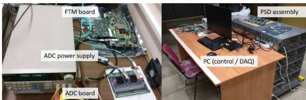
Рисунок 4.1 — Испытательный стенд для разработки системы сбора данных калориметра PSD. Слева: плата ADC, подключенная к плате «FTM board»; справа: фотография стенда по сбору данных с модулей калориметра PSD.
