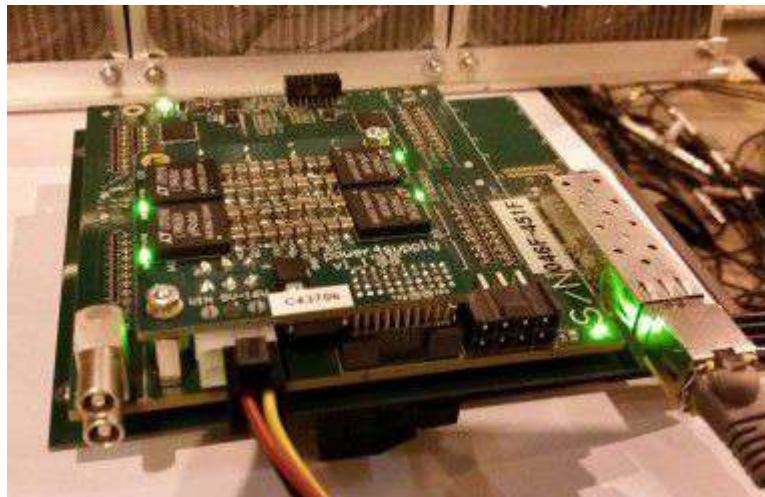
Рисунок 2.9 — Фотография платы АЦП (AFI Electronics ADC64s2) разработанной в ОИЯИ (г. Дубна).
