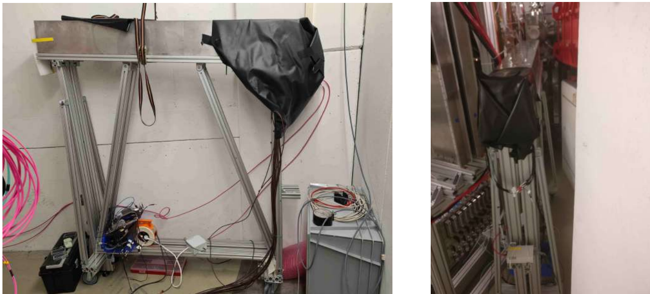
Рисунок 4.6 — Фотография модуля mPSD на установке mCBM в «положении обслуживания» (слева) и направленным на мишень в «пучковом положении» (справа).
