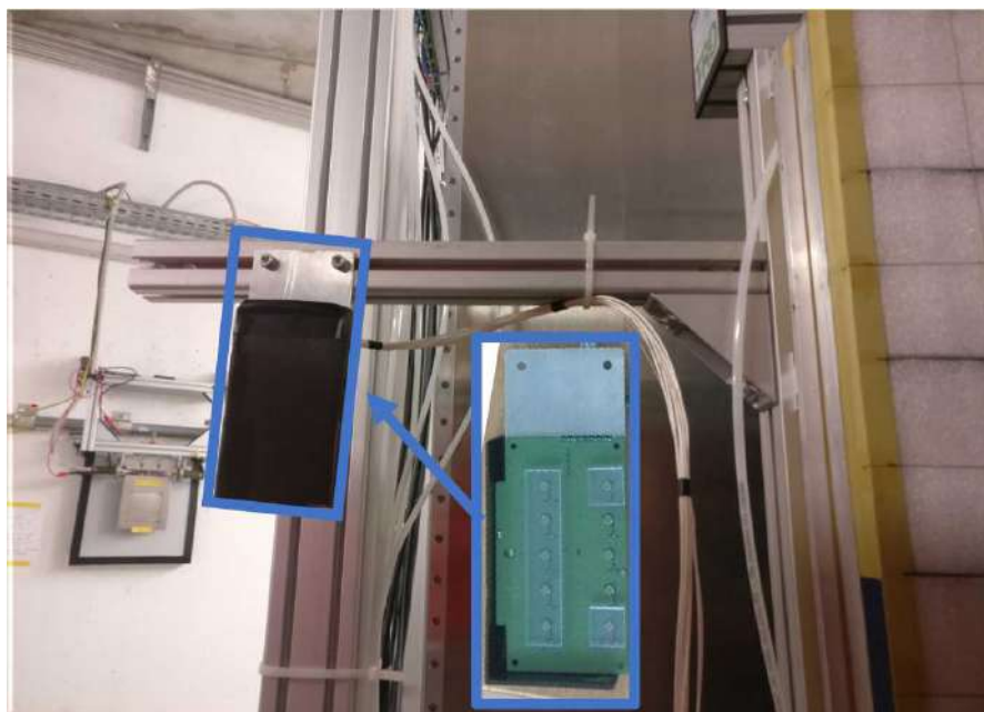
Рисунок 2.13 — Фотография платы с МРРС смонтированной на расстоянии 5 см от пучка на установке mСВМ. Рядом показана фотография платы со сцинтилляционными пластинами, смонтированными на фотодетекторы.
