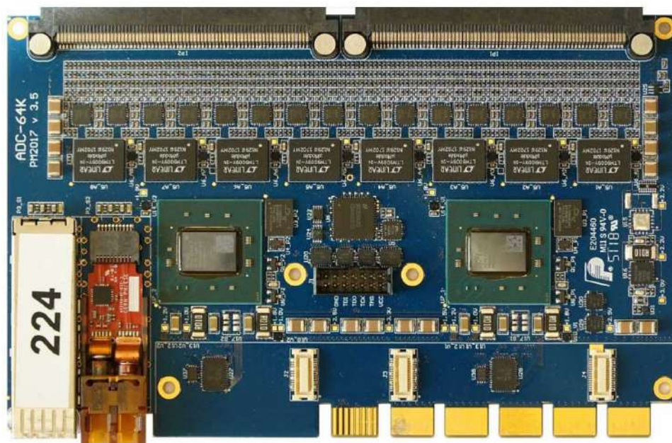
Рисунок 2.11 — Фотография платы ADC разработанной для электромагнитного калориметра эксперимента PANDA.
