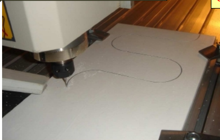
Нарезание канавки S-формы
