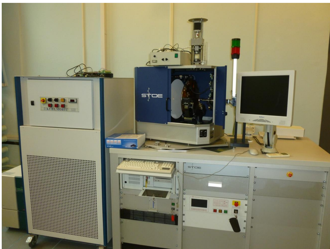
Рисунок 22 - Аппарат с автоматическим контролем усилия и степени растяжения на дифрактометре в ИЯИ РАН.
