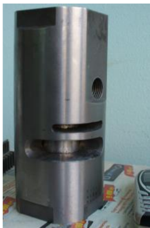
Рисунок 20 - Камеры высокого давления для нейтронных дифракции и спектроскопии, разработанные в ИЯИ РАН.
